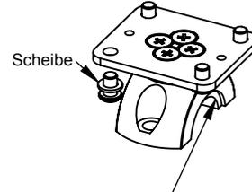
2.1 Dünnere Gummieinlagen für größeren Lenkerdurchmesser und dickere Gummis für kleineren Lenkerdurchmesser wählen.
